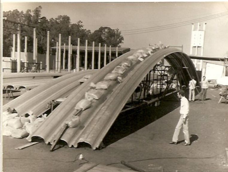
Fotografia 5 - 1º ensaio 2.ª e 3.ª fases de carregamento.
